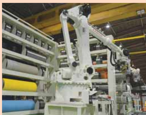
加工指示書データを受け取り、自動刃組装置へ指示を出す機械
