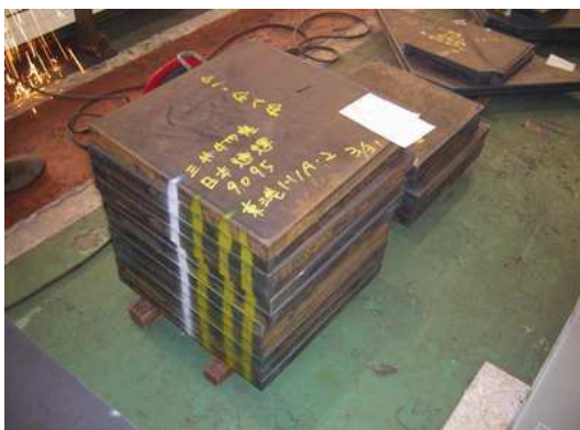
ガス切断製品(鉄骨部材)
